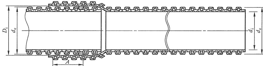
图 2 典型的弹性密封圈连接示意图
