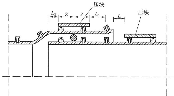
图B.3 在连接密封处压块的定位
