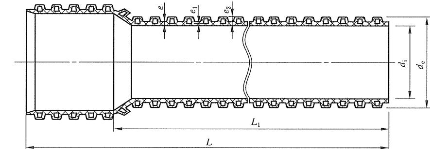
a) 带扩口管材结构示意图
