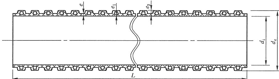
b) 不带扩口管材结构示意图
