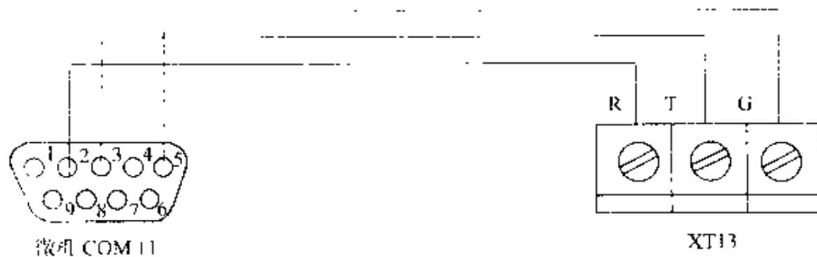
(a) RS232C 口与计算机 COM 口连接示意图
